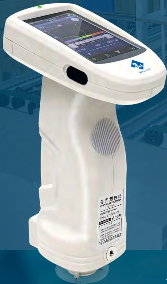
泰双TS7708L在线非接触分光测色仪采用1000线精密闪耀光栅作为分光元件，内置硅光电二极管阵列(双列40组)感应器、进口白板，重复性 $\Delta E^*ab$ 轻松控制在0.08以内，采用高寿命的全光谱LED作为光源，光学分辨率在可见光范围内小于10nm。TS7708L在线非接触分光测色仪测试探头和被测样品非接触测试，实现液体、酱状物、粉末等非接触精密测色。
